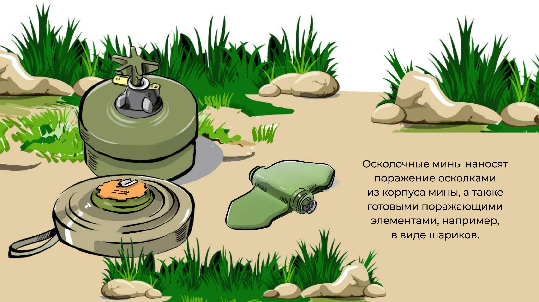
Осколочные мины наносят поражение осколками из корпуса мины, а также готовыми поражающими элементами, например, в виде шариков.
